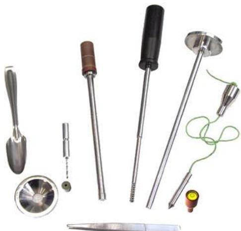
**Espátula y embudo** de alimentación pellets, **Boquilla** de 2,095 mm de Ø de Carburo de Tungsteno, **Herramienta de limpieza** de la boquilla, **Pistón**, **Útil limpieza** del cilindro, **Útil de Extrusión**, **Plomada**, **Nivel de Burbuja** y **Pinzas**.
