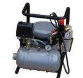
**UN216 Compresor para Laboratorios**, lubricado con aceite Max presión 16 bar, 230V, nivel de ruido: 38 dB (A) / 1m Motor 0,13 Kw; Desplazamiento 17 l/min., tanque de 3.5 litros Dimensiones: 340 x 290 x 340 mm (L x W x H); Peso 18 kg
